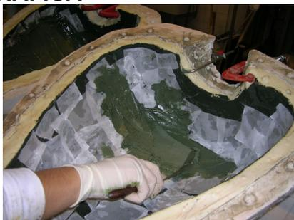
applicazione del secondo strato di resina epossidica più densa
